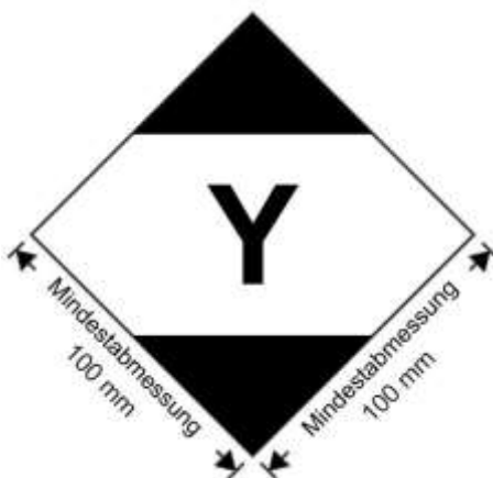
Kennzeichen für Versandstücke, die begrenzte Mengen enthalten, gemäß Teil 3 Kapitel 4 der Technischen Anweisungen der ICAO
